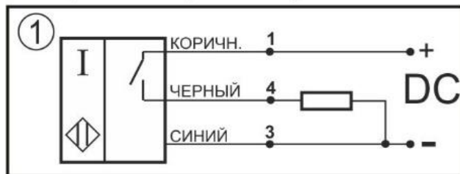
Схема соединения Нормально-разомкнутый контакт
